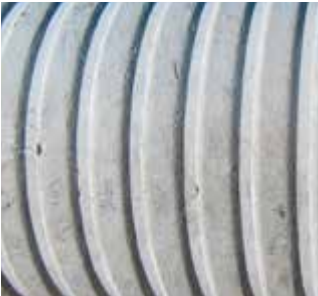
Obwodowe rowkowanie zewnętrzne dla lepszego połączenia z budowlą
