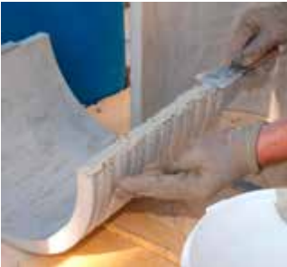
FZR-G 350/300 nanoszenie wypełniacza epoksydowego Z-FZR-G
